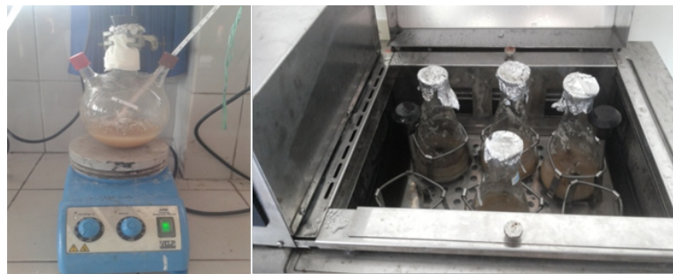
Gambar 2. Proses Hidrolisis dengan magnetic stirrer dan waterbath shaker .
